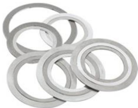
Jointts composés d'un feuilard métallique nervuré et enroulé en spirale, sur un ruban intercalaire sélectionné en fonction de la température et de la nature chimique du fluide. Leur utilisation est compatible avec des températures entre  $-200^{\circ}\text{C}$  et  $+1000^{\circ}\text{C}$  pour des pressions variables de 0 à 350 bars
